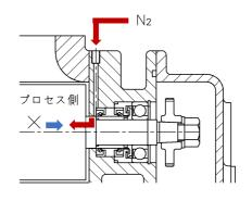
オイルシール間にパージ圧力をかけ、取扱流体の外部 漏出や軸受への流入を防止します さらにパージ量の削減も可能 ポンプ内部(プロセス側)に N<sub>2</sub> を流入させ、内部凝縮液の外部漏出や軸受への流入を防止しますまた、腐食性ガスの希釈やクリーニング効果も可能
